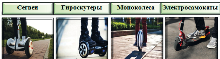
Рис. 17. Средства индивидуальной мобильности, приводящиеся в движение с помощью электродвигателя
